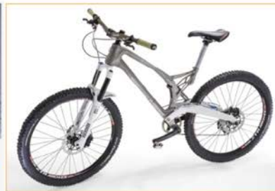
Komplett montiertes Fahrrad mit einem 3D-gedrucktem Rahmen & Sattelstützenhalter aus einer Titanlegierung
