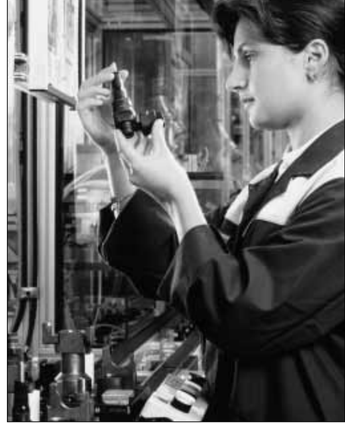
Einspritzpumpen-Fertigung bei Bosch: Sichtprüfung während der Endmontage
