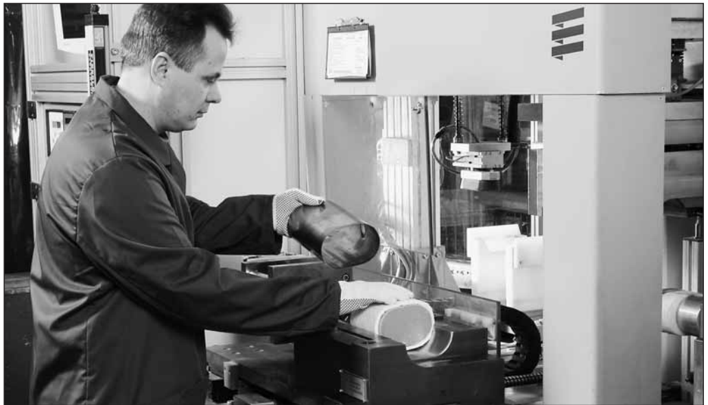
Der keramische Kern und die Metallhülle. Rußfilter von Eberspächer
