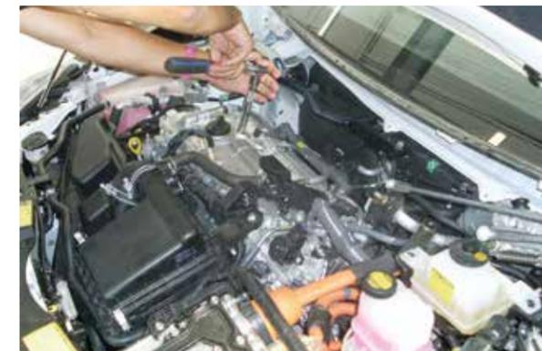
Abbildung 24: Zündkerzenwechsel am Toyota Prius Plug-in-Hybrid (Quelle: Hochschule Esslingen, CAST)
