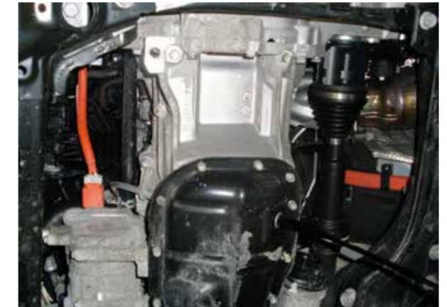
Abbildung 16: Ölwechsel am Toyota Prius Plug-in-Hybrid (Quelle: CAST 2014)
