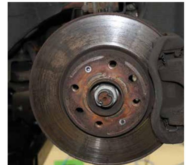
Abbildung 19: Korrodierte, verschlissene Bremsscheibe (Quelle: CAST 2014)
