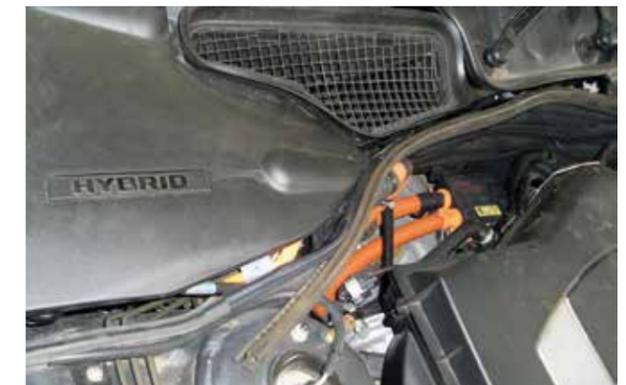
Abbildung 25: HV-Kabelführung im Motorraum Mercedes-Benz S 400 Hybrid (Quelle: Hochschule Esslingen, CAST)
